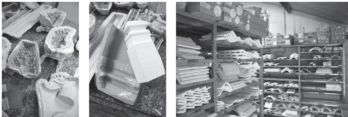
Abbildung 2a-c: Gipsabgüsse architektonischer Dekorteile aus Silikon-Modellen und Dekorlager leichtgewichtiger Dekorplatten (franz. staff ) in jener Dekorationsfirma Auberlet et Laurent in der Nähe von Paris, die schon die Abformungen von Angkor und die Bekleidung der bis zu 60 Meter hohen Angkor-Tempelnachbauten in den französischen Kolonialausstellungen von Marseille 1922 und Paris 1931 ausgeführt hatte; Aufnahme Michael Falser 2010
